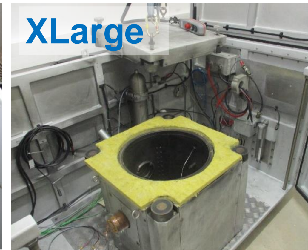
XLarge Ø40 cm x h44 cm Amb → 250°C Ex: Cells under tests: - Cylindrical: Ø54 mm x h 250 mm - Prismatic: 17 x 99 x 310 mm
