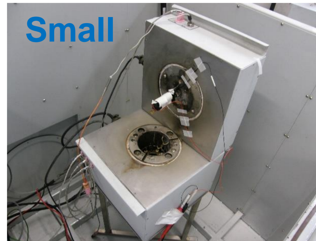
Small Ø10 cm x h10 cm Amb → 250°C Ex: Cells under tests: - Cylindrical: 18650 / 21700 / 26650 - Prismatic: 5 x 34 x 37 mm
